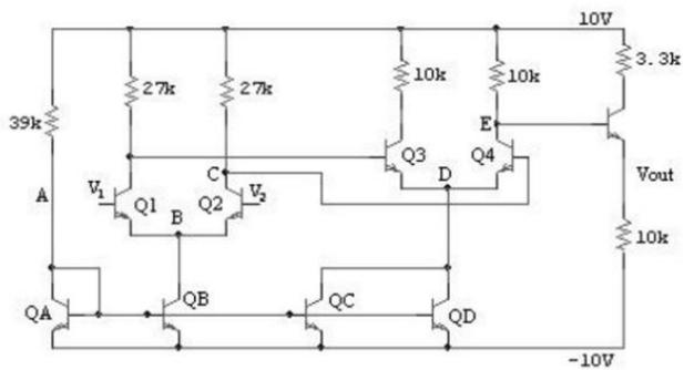
**Problema 4:** Halle las resistencias:  $R_1$ ,  $R_2$ ,  $R_3$ ,  $R_4$  y  $R_5$  de manera que circule las corrientes indicadas, para ello, considere:  $V_{CC}=10V$ ,  $\beta=100$ . calcule la Ganancia de Voltaje, la Impedancia de Entrada y la Impedancia de Salida.
