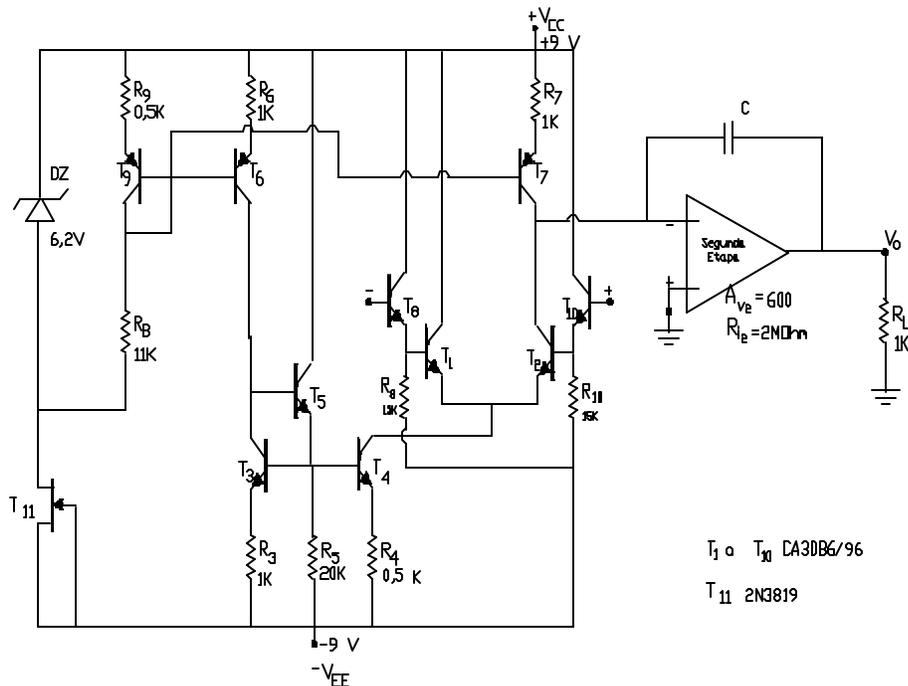
En el circuito de la figura arriba indicada, desde el punto de vista de la C.C., a la  $I_{DSS}$  del transistor  $T_{11}$  el Diodo Zener (D.Z.) opera en su región de ruptura (notar que dicho diodo esta polarizado inversamente), presentando entre sus bornes la tensión de referencia  $V_R = 6,2$  Volt. Además el circuito de entrada de la Segunda Etapa impone en la unión de los colectores de  $T_7$  y  $T_2$  una tensión de 1,2 Volt con relación a masa.
